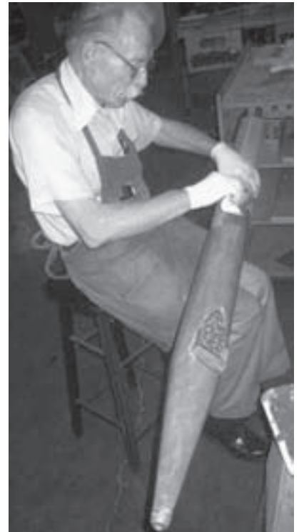
Bob Schertle mottling façade pipe
