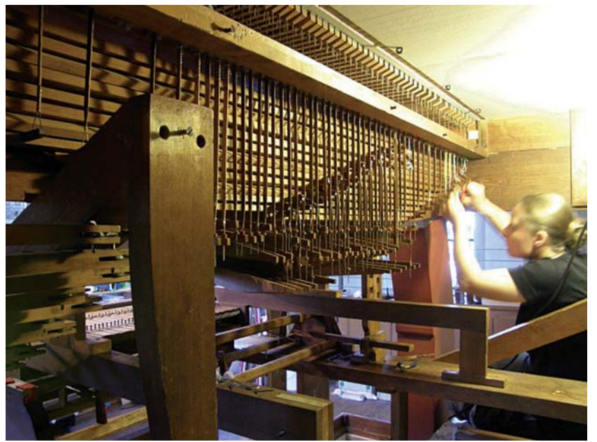
Sonja Füßmann installs trackers
